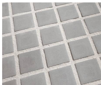
BEST AKVAGRAS , modulární skladební rozměr 200 x 200 mm (vč. spár), tl. 80 mm, pravidelné spáry šířky 30 mm, zkosená hrana (fazeta), barva přírodní
