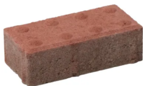
Reliéfni hmatová dlažba, modulární skladební rozměr 100 x 200 mm, tl. 80 mm, zkosená hrana (fazeta), barva červená
